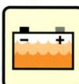
バッテリの液量が規定範囲内にあるかチェック（UPPERとLOWERの間）。不足している場合は、専用液を補充。バッテリ液は腐食性が強いため、注意。
